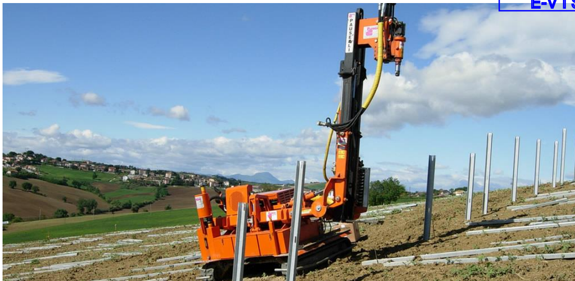
Ilustración 8: Máquina hinca postes. Fuente: Pauselli Group
